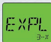
Explosimeter 3 scales : PPM, % LEL, % Vol. gas
