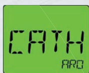
Explosimeter-catharometer 2 scales : % LEL & % Vol. gas
